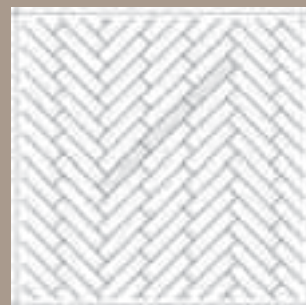
Diagonalt Fiskben 3 på rad i 1/3-format.
