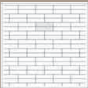
Löpförband dubbelt 1/3-format m 1/2 förskj.
